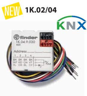
Включает в себя 2 цифровых входа для контактов без напряжения и 2 выхода для светодиодов.
